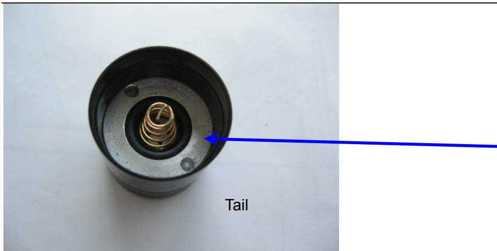
Иногда фонарь начинает мигать и не включается/выключается правильно. Рекомендуется вставить пинцет в отверстия внутри отвинчивающейся кнопки и затянуть крепление потуже по часовой стрелке
