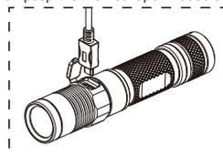
При нормальных условиях зарядки синий индикатор питания будет непрерывно гореть. Когда батарея полностью заряжена, MH10 автоматически прекратит процесс зарядки и синий индикатор питания погаснет.
