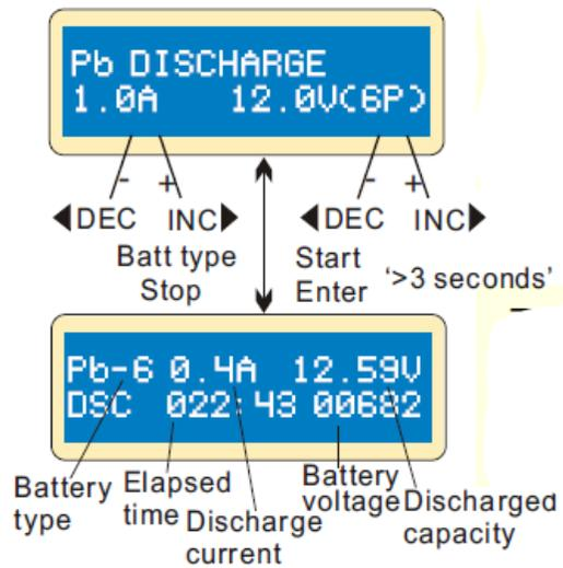
Установите разрядный ток в левой части дисплея и номинальное напряжение в правой части. Разрядный ток может быть 0.1-1.0A, напряжение должно выставлено соответственно разряжаемой батарее. Нажмите и удерживайте более 3-х секунд кнопку **START/ENTER** для запуска разрядки.
